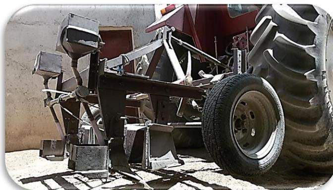
Fotografía: Sembradora adaptada al tractor<sup>9</sup>
